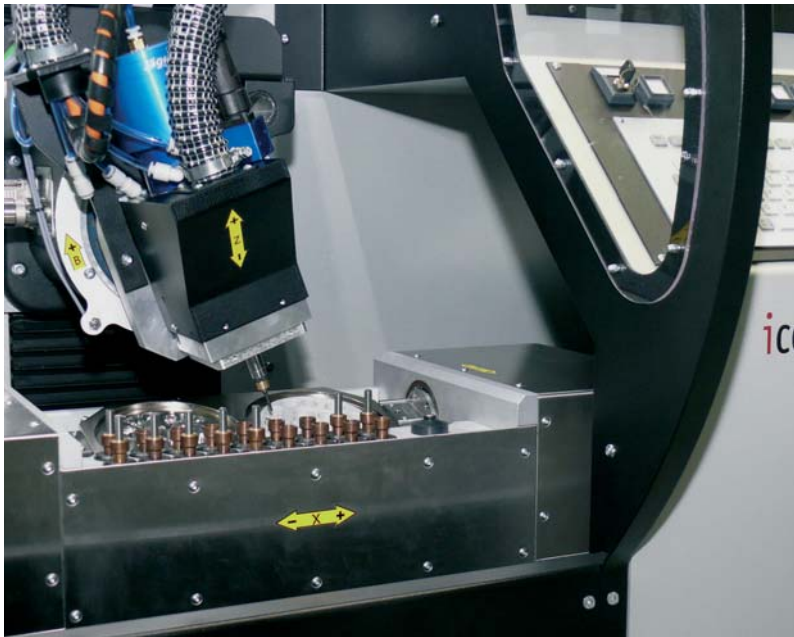
Detailsicht 550i: Hochleistungs-5-Achsmaschine für alle fräsbaren Dentalwerkstoffe.
