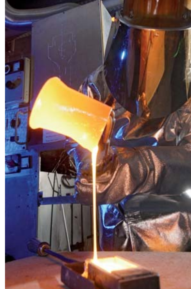
Die Glaskeramiken werden gemäß einem genau angegebenen Temperaturschema erzeugt (Foto: Jan-Peter Kasper/FSU).
