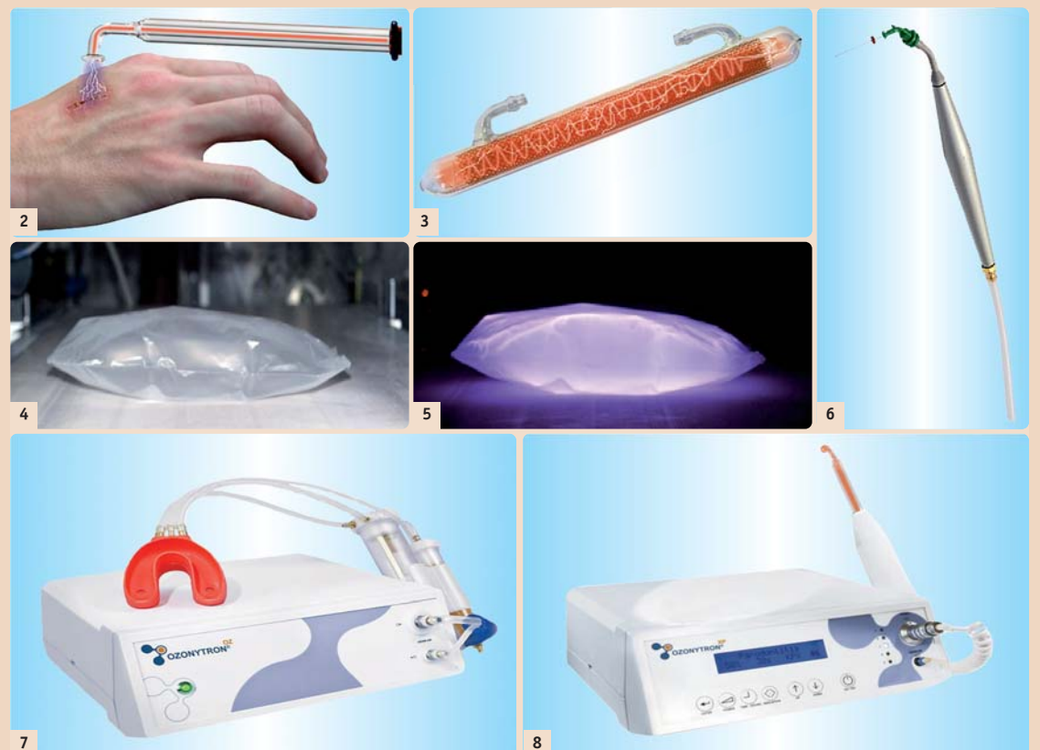
Abb. 2: Aufnahme einer Plasmawolke (unsichtbar): offener Generator mit Plasmaelektrode der Fa. MIO Int. OZONYTRON. – Abb. 3: Geschlossener Plasmagenerator der Fa. MIO Int. OZONYTRON. – Abb. 4: Mit speziellem Gasgemisch gefüllter Beutel. – Abb. 5: Durch Anlegen einer Hochspannung zu Plasma aktiviertes Gasgemisch. – Abb. 6: Bei einzelnen Zahnfleischtaschen, Wurzelkanälen oder Fisteln eignet sich mehr die handliche KPX-Düse. – Abb. 7 und 8: Zwei Geräte zur Anwendung in der Plasmamedizin für die Dentalmedizin, Wundheilung, Dermatologie, HNO, Gynäkologie, Urologie und Orthopädie, Ozonwasser-Produktion sind hier vorgestellt (OZONYTRON-XP/OZ).
