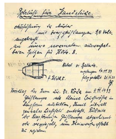
Abb. 1: Konstruktionsskizze für die Entwicklung eines Handstückes mit Lichtleiter aus dem Jahre 1933 (Archiv W&H).
