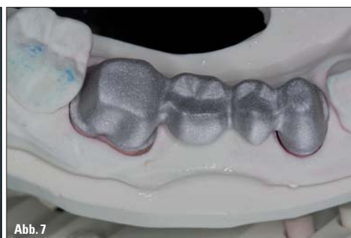
Abb. 6: Gerüst nach Entfernen der Supports. – Abb. 7: Um das Gerüst in Beziehung zu den Nachbarzähnen und zum Gegenbiss verblenden zu können, ist auch im digitalen Workflow ein reales Modell erforderlich. Parallel erfolgt die Fertigung des CAM-Modells (gefrästes Modell auf Grundlage der digitalen Daten) durch Align/Strumann. – Abb. 8: Gerüst auf Cadent-Modell.
