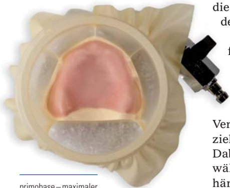
primobase – maximaler Anpressdruck und damit bestmögliche Passung, wenn die primobase-Platte während der Lichthärtung in der Metavac-Einheit tiefgezogen wird.
