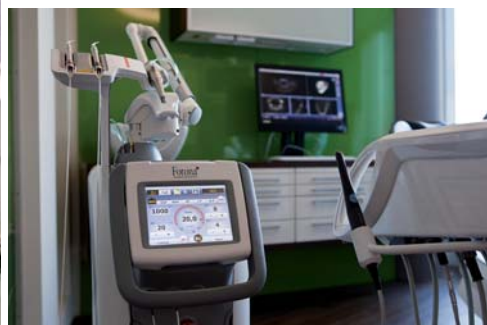
Abb. 1: Der Fidelis 3 Plus der Firma Fotona als Beispiel für ein Kombinationsgerät mit zwei verschiedenen Wellenlängen (Er:YAG und Nd:YAG). – Abb. 2: Der Lightwalker der Firma Fotona zeigt als Weiterentwicklung des Fidelis 3 eine deutliche Vereinfachung beim Wechsel der Wellenlängen und der voreingestellten Programme. – Abb. 3: Präparation einer Kavität im Seitenzahngebiet mit dem Er:YAG-Laser in der Praxis.
