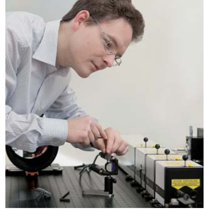
Bernhard Zachhuber beim Montieren optischer Elemente des Spektrometers.
