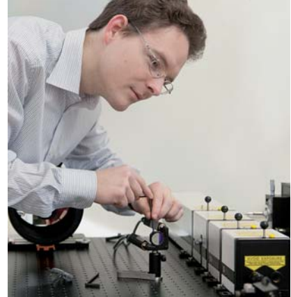
Bernhard Zachhuber beim Montieren optischer Elemente des Spektrometers.
