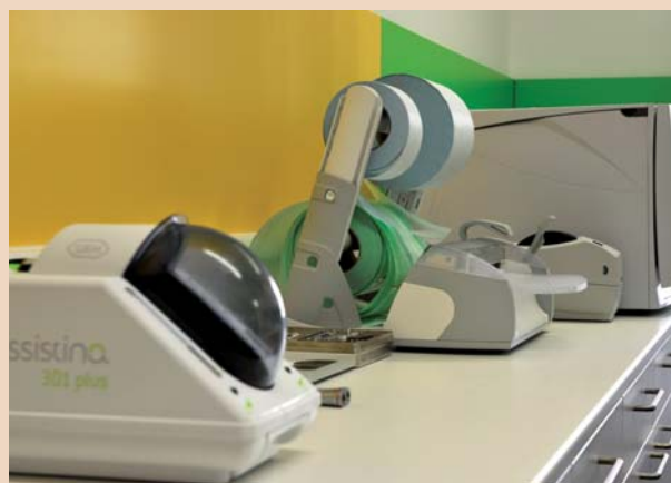
Sterilisator „Lisa“ mit Etikettendrucker, Folienschweissgerät und das Turbinen- und Winkelstückreinigungsgesetz „assistina 301 plus“ von W&H.
