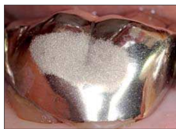
Abb. 3: Makroretentives Konditionierungsmuster nach Pulverstrahlen mit Al 2 O 3 .
