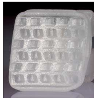
Abb. 7: Spritzgusskeramik mit Makroretentionen und spezieller Randgestaltung für eine definierte Bracketadhäsivmenge und einen entsprechenden Abfluss des Bracketadhäsivüberschusses (QuickClear®, Fa. FORESTADENT).
