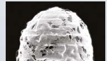
Benutzte galvanisierte Bohrerspitze
