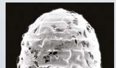
Benutzte galvanisierte Bohrerspitze
