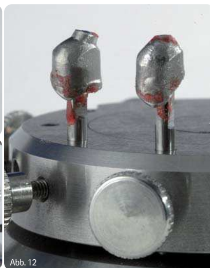
Abb. 8: Das Sägmodell mit den Innenkoni auf dem Modellträger. – Abb. 9: Mit Pattern Resin werden die Konuskronen fixiert. – Abb. 10: Die Pins werden in die Bohrungen des Außenringes gesteckt. – Abb. 11: Das Lumen der Kronen wird mit Pattern Resin ausgefüllt. – Abb. 12: Jeder Innenkonus ist frei zugänglich und kann problemlos bearbeitet werden.
