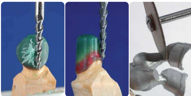
Abb. 1: Die Wachsspäne werden gut abtransportiert. – Abb. 2: Hohlkehlen lassen sich mit dem gleichen Fräser erzielen. – Abb. 3: Abtrennen der Innenkoni mit der Trennscheibe aus dem NEM-Verarbeitungsset.
