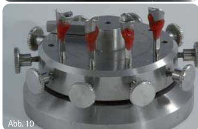
Abb. 8: Das Sägmodell mit den Innenkoni auf dem Modellträger. – Abb. 9: Mit Pattern Resin werden die Konuskronen fixiert. – Abb. 10: Die Pins werden in die Bohrungen des Außenringes gesteckt. – Abb. 11: Das Lumen der Kronen wird mit Pattern Resin ausgefüllt. – Abb. 12: Jeder Innenkonus ist frei zugänglich und kann problemlos bearbeitet werden.
