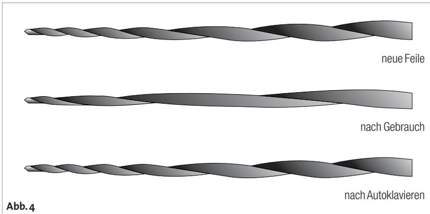
hoher Temperatur erreicht. Dadurch gewinnt das Instrument wieder nahezu die Ausgangsstabilität eines neuen Instrumentes (Abb. 4). Während andere Instrumente nach jeder Anwendung linear an Bruchsicherheit verlieren, bleibt HyFlex™ CM zehn Kanäle lang nahezu stabil (Gambarini et al. 2011). Coltène/Whaledent verspricht eine erhöhte Bruchsicherheit von bis zu 300 Prozent gegenüber anderen Herstellern.
