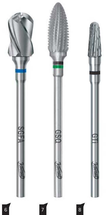
Abb. 6: Speziell für Gips – die seit 1990 ausgelieferte SGA-Verzahnung hat einen großen Spanraum zur Aufnahme der Späne. – Abb. 7: Die GSQ-Verzahnung ist eine schnittfreudige Verzahnung mit Querhieb speziell für die Bearbeitung weichbleibender Silikonmaterialien und Softkunststoffe. – Abb. 8: Für Titan benötigt man Fräser mit ausgeprägtem Querhieb. Der verhindert das Überhitzen. Für Schrump-Arbeiten ist die besonders grobe GTI-Verzahnung konzipiert.
