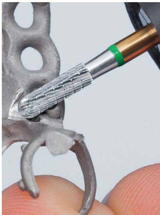
Abb. 5: Komfortabel und beliebt – das Arbeitsteil der Piccolo-Fräser ist auf 8 Millimeter verkürzt.
