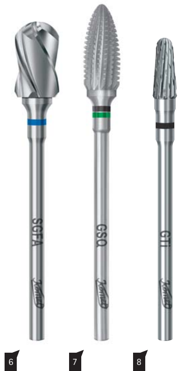
Abb. 6: Speziell für Gips – die seit 1990 ausgelieferte SGA-Verzahnung hat einen großen Spanraum zur Aufnahme der Späne. – Abb. 7: Die GSQ-Verzahnung ist eine schnittfreudige Verzahnung mit Querhieb speziell für die Bearbeitung weichbleibender Silikonmaterialien und Softkunststoffe. – Abb. 8: Für Titan benötigt man Fräser mit ausgeprägtem Querhieb. Der verhindert das Überhitzen. Für Schrump-Arbeiten ist die besonders grobe GTI-Verzahnung konzipiert.
