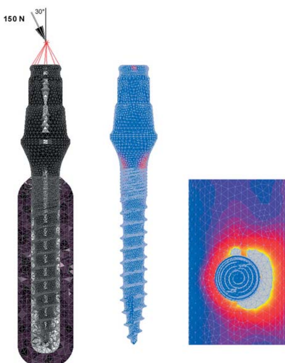
Abb. 1: Finite-Elemente-Modell eines experimentellen Mini-Implantats im idealisierten Knochensegment einer Unterkieferfront (links). Berechnete Spannungen im Implantat. Die Spannungen sind im Bereich des Durchtritts durch die Kortikalis am höchsten (rote Bereiche, Mitte). Das rechte Teilbild zeigt eine Aufsicht auf die Kortikalis. In den grauen Bereichen ist der Knochen überlastet. 5
