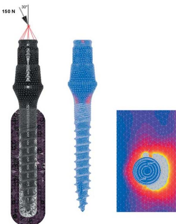
**Abb. 1:** Finite-Elemente-Modell eines experimentellen Mini-Implantats im idealisierten Knochensegment einer Unterkieferfront (links). Berechnete Spannungen im Implantat. Die Spannungen sind im Bereich des Durchtritts durch die Kortikalis am höchsten (rote Bereiche, Mitte). Das rechte Teilbild zeigt eine Aufsicht auf die Kortikalis. In den grauen Bereichen ist der Knochen überlastet.<sup>5</sup>
