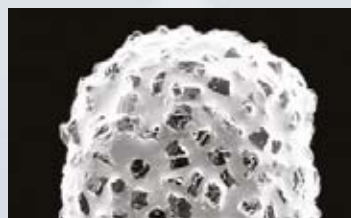
Benutzte Two Striper® Bohrerspitze
