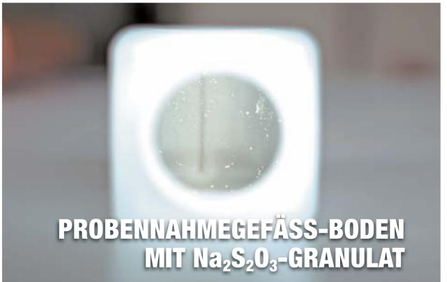
**PROBENNAHMEGEFÄß-BODEN MIT  $\text{Na}_2\text{S}_2\text{O}_3$ -GRANULAT**
