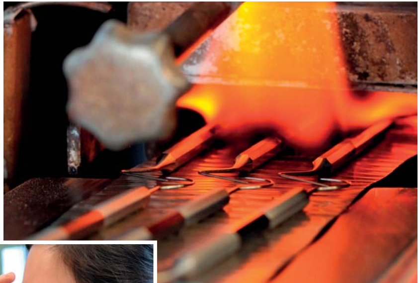
Oben: Härten der Stahlinstrumente. – Links: Das wohl wichtigste Utensil der Mitarbeiter ist die Lupe.
