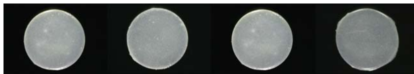
▲ Abb. 2: Mit zunehmender Verdichtung erhöht sich die Transluzenz der Brennproben. VINTAGE ZR T-Glass v.l.n.r.: ohne Verdichtung, Handverdichtung, Ultraschallverdichtung schwach, Ultraschallverdichtung intensiv.
