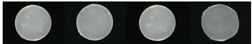
▲ Abb. 2: Mit zunehmender Verdichtung erhöht sich die Transluzenz der Brennproben. VINTAGE ZR T-Glass v.l.n.r.: ohne Verdichtung, Handverdichtung, Ultraschallverdichtung schwach, Ultraschallverdichtung intensiv.
