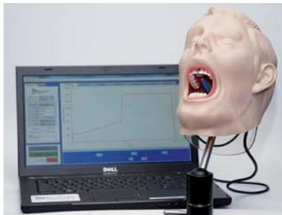
▲ Abb. 1: Das MARC-System besteht aus einem Phantomkopf, in den kalibrierte Sensoren eingebaut sind. Ein angeschlossener Laptop verarbeitet die Daten und zeigt sie an, als Kurven oder Tabellen.
