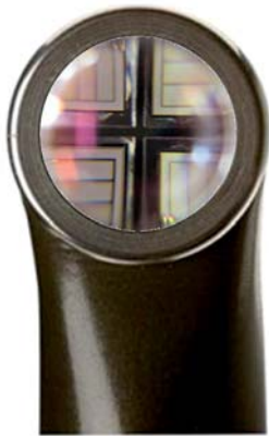
▲ Abb. 3: Im Inneren des VALO-Kopfes: Vier LEDs, die insgesamt ein Spektrum von 395–480 nm abdecken. Eine Sammellinse bündelt das Licht zu einem homogenen Feld.
