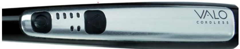
▲ Abb. 5: Die Bedienung von VALO und VALO Cordless zur Wahl von Modus und Zeiten ist praktisch gleich. Die Cordless-Version besitzt eine zusätzliche Batterie-Kontrollleuchte.
