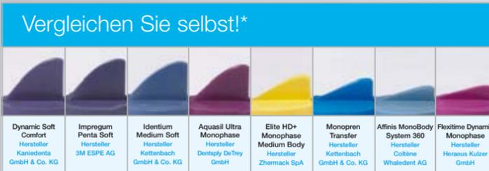
\* Haifischflossen-Test nach der Methode der Tufts University, Boston. Zeitpunkt der Belastung: 45 Sek. nach Mischbeginn. Je höher die Haifischflosse, desto besser fließt das Abformmaterial.
