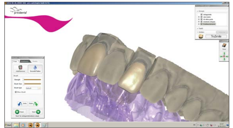
Abb. 3: Mit den Freiform-Werkzeugen lässt sich der Kronenrohling individuell anpassen.
