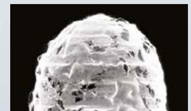
Benutzte galvanisierte Bohrerspitze
