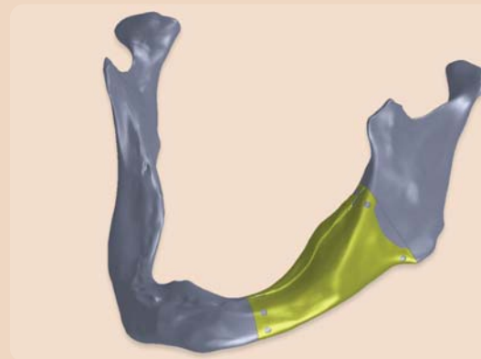
Virtuelles 3-D-Modell eines Unterkieferknochens mit eingepasstem Implantat. Die äußere Schale des Implantates folgt der Kontur des entfernten Kieferbereiches. Die Herstellung des Implantates erfolgt mit dem schichtweise arbeitenden Verfahren „LaserCUSING“.
