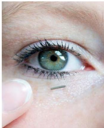
in dem Fraunhofer-Technologie steckt. Die Idee dahinter: Ein Biosensor, der sich am Körper des Patienten befindet, könnte den Glukosespiegel kontinuierlich auch in anderen Gewebsflüssigkeiten als Blut messen, wie etwa im Schweiß oder in der Augenflüssigkeit. Die ständige Pikserie entfällt. Doch bisher waren solche bioelektrischen Sensoren zu groß, zu un-
