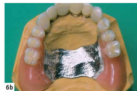
Abb. 6a, b: Kombination eines brückenförmigen Prothesengerüsts auf Teleskopkronen und Wurzelstiftkappen aus hochgoldhaltiger Legierung mit netzförmigen Sattelverstärkungen und Palatinalband aus Kobalt-Basislegierung. Die Gerüstteile aus unterschiedlichen Legierungen sind durch Kleben gefügt. Heterogenes Löten und Schweißen sind aus materialtechnischer Sicht kontraindiziert.
