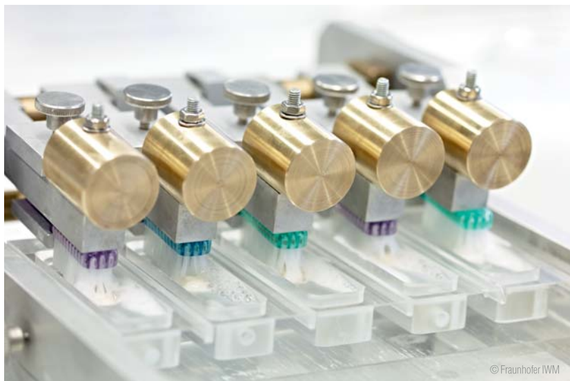
Ihre mikrotribologischen Analysen der Wechselwirkungen zwischen Zahnbürsten, Zahncremes und der Zahnoberfläche wollen die Forscher künftig durch praxisnahe Tests mit einer eigens entwickelten Zahnputzmaschine ergänzen. Rechts unten im Bild: Reib- und Verschleißtests mit einzelnen Borsten.
