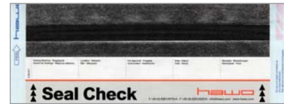
▲ Abb. 5: hawo Seal Check zur routinemäßigen Überprüfung der Siegelnahte.
