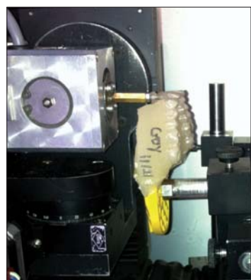
Abb. 8: Einbau des Patientenmodells in das OMSS. Links ist der Kraft/Drehmomentsensor zu erkennen, der mit dem aus dem Modell herausgetrennten Zahn verbunden ist. Die Schiene ist auf das Modell aufgesetzt und überträgt das Kraftsystem auf den Zahn.
