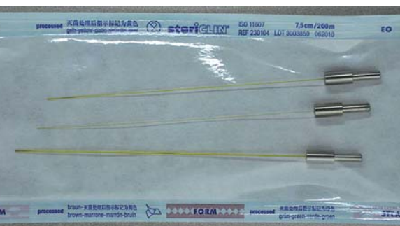
Abb. 1: Fasern zur Vorbereitung für die Sterilisation in einer Papier-Kunststoff-Folie. – Abb. 2: Messaufbau zur Leistungsmessung der sterilisierten Fasern. Oben rechts der Dentallaser ( \lambda = 810 nm, aktiviertes Display), unten links das Radiometer (grau). Vor dem Handstück ist der Messkopf (blau) positioniert. – Abb. 3: Ausschnittbild des Biegemessplatzes FLEX. Dargestellt sind hier die beiden Rotationstische (oben und unten) und in der Mitte die Spannvorrichtung (zwei Spannbacken) mit eingespannter Faser. Der untere Rotationstisch wird zusätzlich linear bewegt. 5
