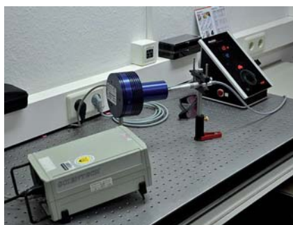
Abb. 1: Fasern zur Vorbereitung für die Sterilisation in einer Papier-Kunststoff-Folie. – Abb. 2: Messaufbau zur Leistungsmessung der sterilisierten Fasern. Oben rechts der Dentallaser ( \lambda = 810 \text{ nm} , aktiviertes Display), unten links das Radiometer (grau). Vor dem Handstück ist der Messkopf (blau) positioniert. – Abb. 3: Ausschnittbild des Biegemessplatzes FLEX. Dargestellt sind hier die beiden Rotationstische (oben und unten) und in der Mitte die Spannvorrichtung (zwei Spannbacken) mit eingespannter Faser. Der untere Rotationstisch wird zusätzlich linear bewegt. 5
