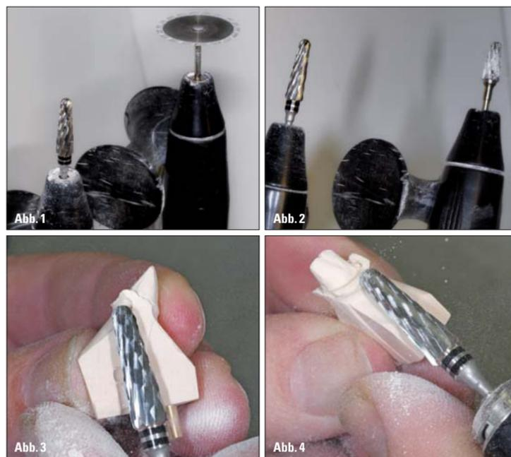
**Abb. 1:** Sägen und Beschleifen der Gipsstümpfe ohne weiteren Werkzeugwechsel. – **Abb. 2:** Neue und alte Form der Gipsfräse, das gewohnte Handling bleibt. – **Abb. 3:** Die Länge der Gipsfräse macht den Unterschied. Der Gipsstumpf kann in einem Arbeitsgang von oben bis unten beschliffen werden. – **Abb. 4:** Hohlkehlinstrumente präparieren und Versäubern ohne Werkzeugwechsel.
