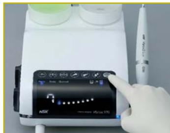
verfügt über zwei unabhängige Kühlmittelflaschen von je 400ml und ein großes, intuitiv nutzbares Bedienfeld sowie ein Display, auf dem alle aktuellen Einstellungen übersichtlich angezeigt werden. Als Varios 170 können die Vorteile des Varios 2-Handstücks auch in die vorhandene Behandlungseinheit integriert werden.
