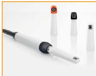
in jeder Aufnahmesituation die optimale Anwendung der Funktionalitäten „Still/Live“ und „Speichern“ ermöglicht, und die Sensitive-Control-Funktion, die das Auslösen fühlbar am Handstück bestätigt, gehören zur Grundausstattung der VistaCam iX. Ein integrierter Bewegungssensor ermöglicht ein automatisches An- und Abschalten.
