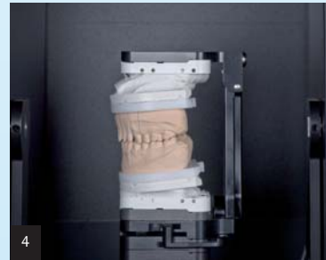
Abb. 2: Einstellen der Frontzahnführung anhand von Situationsmodellen als Ausgangssituation für die herzustellende Frontzahnrestauration. – Abb. 3: Artex® CR mit präpariertem Meistermodell und nach eingestelltem Frontzahnführungsteller. – Abb. 4: Umsetzen der einartikulierten Situation in den Ceramill Fixator ohne Präzisionsverlust. Ceramill Fixator eingesetzt in Ceramill Map400 Scanner auf Splitex®-Präzisionsbasis.
