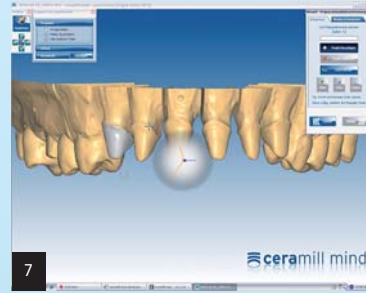
Abb. 5: Ergebnis nach dem Scan des artikulierten Modellpaares. – Abb. 6: Scanergebnis des Situationsmodells. – Abb. 7: Festlegen der Präparationsgrenzen.
