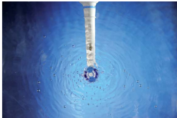
Hydrodynamische Effekte und Kavitation bei der oszillierend-rotierenden Zahnbürste. Bildquelle: Dr. med. dent. Alessandro Devigus
