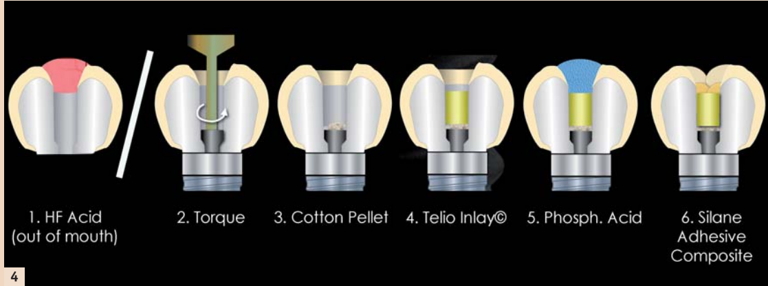
Abb. 4: Schematischer Querschnitt des Zugangskanals, der das klinische Schritt-für-Schritt-Verfahren deutlich macht: 1. Flußsäure-Ätzung (HF-Ätzung) der Feldspatkeramikschiicht (außerhalb des Mundes). – 2. Abschließende Torque-Verschraubung. – 3. Schutz des Schraubenkopfes (Baumwollpellet). – 4. Füllung mit einem belastbaren Material. – 5. Phosphorsäurereinigung der Feldspatkeramikschiicht. – 6. Silanisierung. – Ohne Abbildung: 7. Klebstoffschicht. – 8. Polymerisation des Klebstoffes. – 9. Füllung des Kanals mit Compositeharz (Mehrschichttechnik). – 10. Polieren.
