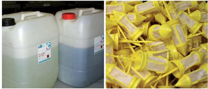
Abb. 4 und 5: Kanister für die Sammlung von Röntgenflüssigkeiten und Filter für Absauganlagen.
