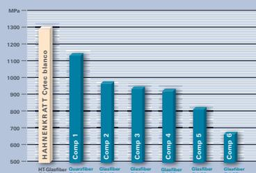
Höchste Biegefestigkeit nach DIN 53 390 für Cytec blanco, HT-Glasfaser: 1.281,62 MPa im Vergleich zu anderen Wurzelstiften aus Glas- oder Quarzfaser
