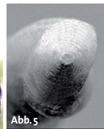
Abb. 3: Querschnitt einer RECIPROC® Feile. – Abb. 4: Querschnitt einer WaveOne™ Feile – 13 mm, 6 mm und 3 mm von der Feilenspitze. – Abb. 5: Nicht schneidende Führungsspitze RECIPROC®.
