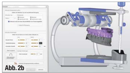
▲ Abb. 2a und b: Datenerfassung (a) und Dateneingabe in den Artikulator (b).
