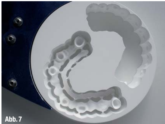
▲ Abb. 7: Fall 2 – Gefräste Brücke im Zirkonrohling, mit Sintersteg zur Stabilisierung während des Sinterbrandes. ▲ Abb. 8: Fall 3 – PMMA Provisorium unmittelbar nach dem Fräsen im Rohzustand, vor der Politur.
