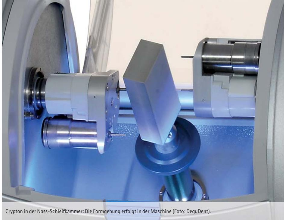
Crypton in der Nass-Schleifkammer: Die Formgebung erfolgt in der Maschine (Foto: DeguDent).
