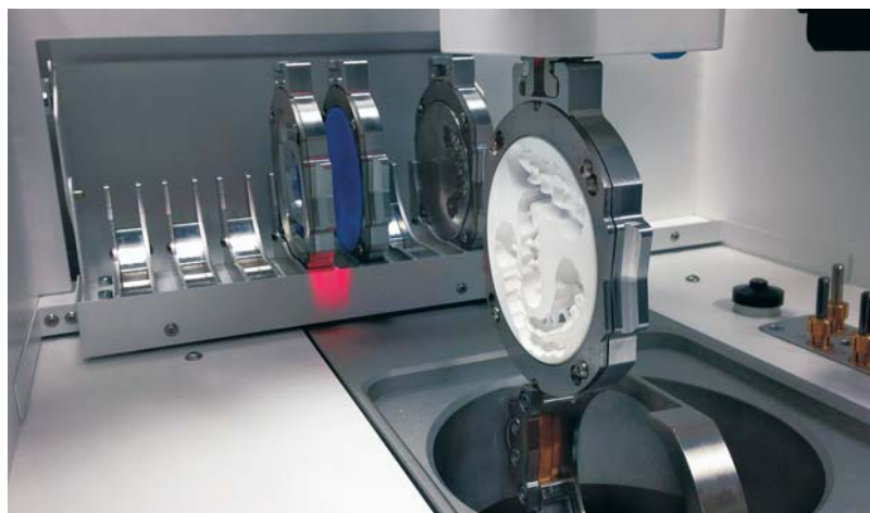
Abb. 2: Optional erhältlich Automationssystem für sieben Blanks.
