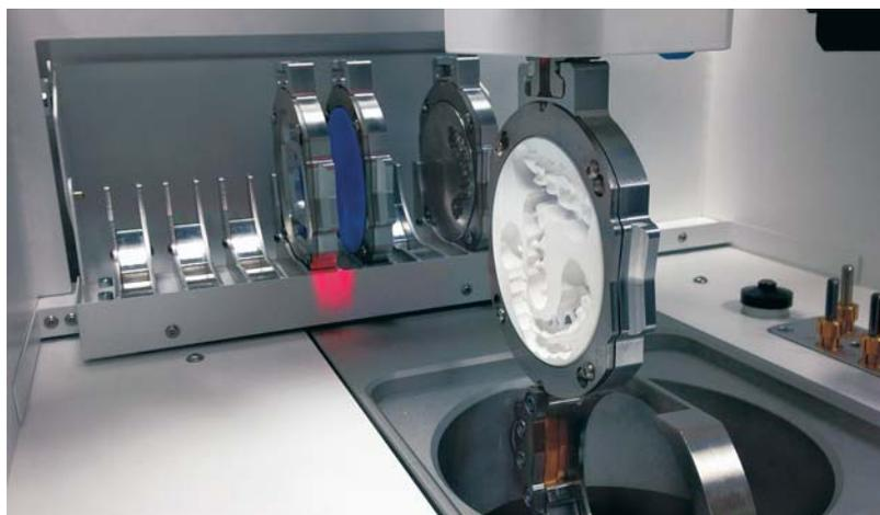
Abb. 2: Optional erhältlich Automationssystem für sieben Blanks.
