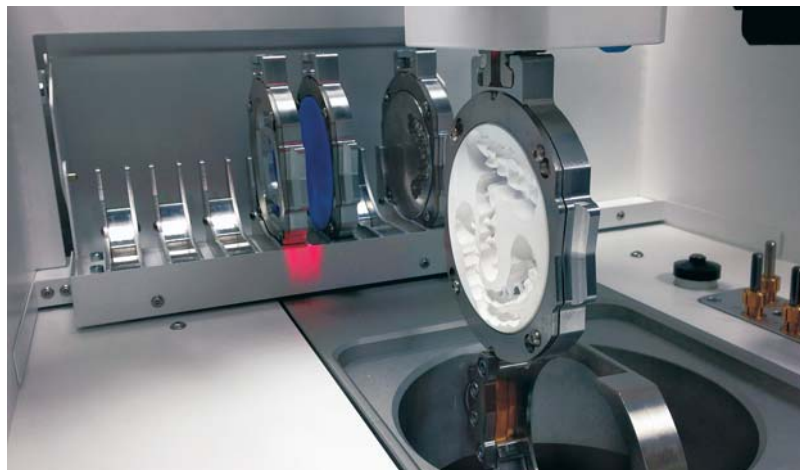
Abb. 2: Optional erhältliches Automationssystem für sieben Blanks.
