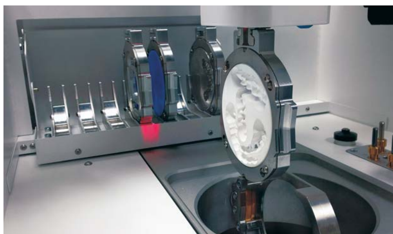
Abb. 2: Optional erhältliches Automationssystem für sieben Blanks.
