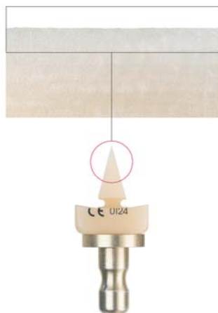
Abb. 3: Hohe Kantenstabilität bei dünn auslaufenden Restaurationsrändern ist garantiert. Darstellung Randbereich VITA ENAMIC 30° Keil. Quelle: VITA Forschung und Entwicklung
