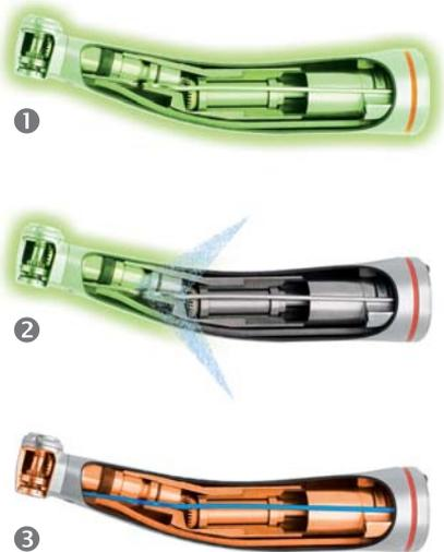
1: Innenreinigung der Spraykanäle und Getriebeteile, Außenreinigung des Instruments. – 2: Durchblasen der Spraykanäle mittels Druckluft. – 3: Schmierung der Getriebeteile mit W&H Service Oil F1.
