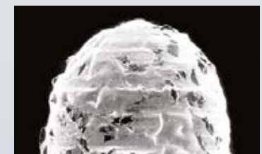
Benutzte galvanisierte Bohrerspitze
