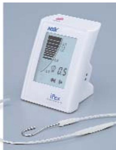
lichen Umständen auftreten können, werden von der zum Einsatz kommenden Multi-Frequenz-Messsoftware-Technologie zuverlässig herausgefiltert. Der iPex wählt automatisch die bestmögliche Kombination der Frequenzen aus, um sich den Gegebenheiten im Wurzelkanal des jeweiligen Patienten anzupassen. Wird das Gerät zehn Minuten lang nicht genutzt, schaltet es automatisch ab und verlängert somit die Batterielaufzeit.
